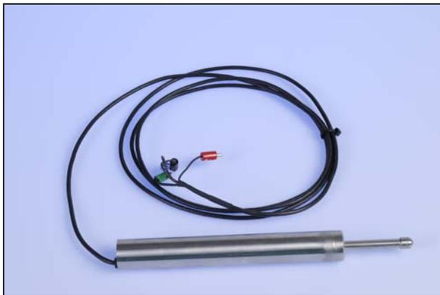
Bei dem Sensor den wir als Testobjekt nehmen, um unsere Messeinrichtung zu testen, handelt es sich um einen Standard-LVDT-Wegaufnehmer der Firma disynet. Der MTN/EUS10-10, den wir verwenden, verfügt über eine integrierte Elektronik, die uns eine Ausgangsspannung von 0 – 10 V liefert. So können wir den Sensor direkt an unser USB-Messlabor anschließen.
